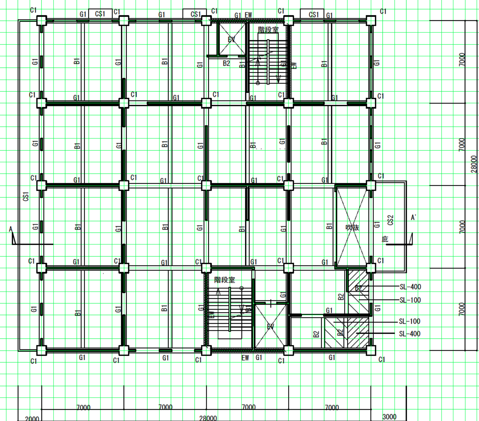
2階梁伏図 (縮尺1/200) (2階から見下げる図とする) ※スラブは特記以外は全てS1とする ※SLは、スラブの厚さを示す。
